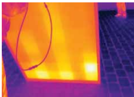
Ces images de l'arrière du même panneau solaire comportent beaucoup moins de reflets qu'à l'avant ; les mesures de température gagnent donc en exactitude.
