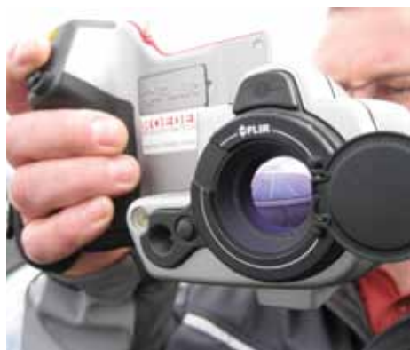
La caméra thermique FLIR T335 est proposée avec plusieurs objectifs interchangeables.
