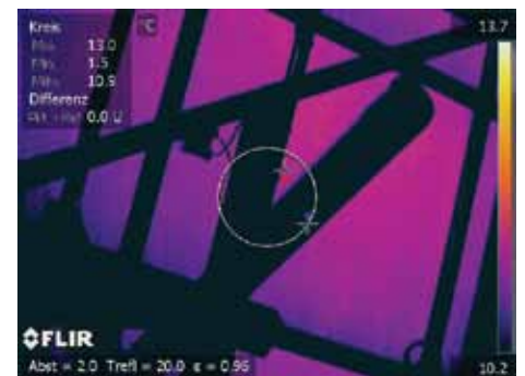
Les points chauds de cette image thermique prise à l'avant du panneau solaire semblent indiquer que de nombreuses cellules sont inefficaces.
