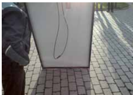
Ces images de l'arrière du même panneau solaire comportent beaucoup moins de reflets qu'à l'avant ; les mesures de température gagnent donc en exactitude.
